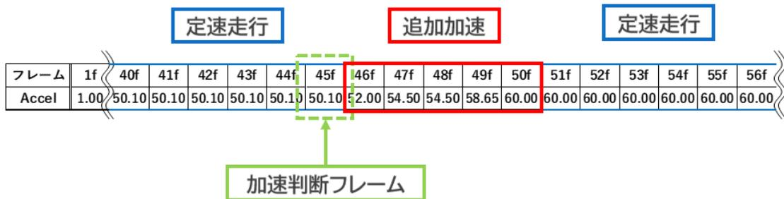
図 3.9: 定速走行と追加加速および加速判断時刻の例
