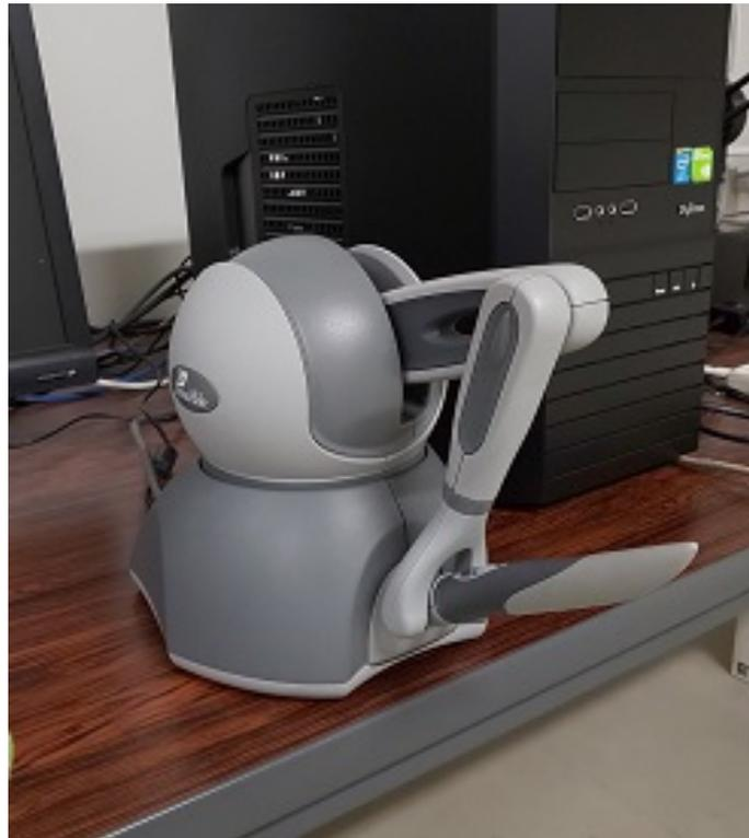
図 2.3: 使用したデバイス PHANTOM
