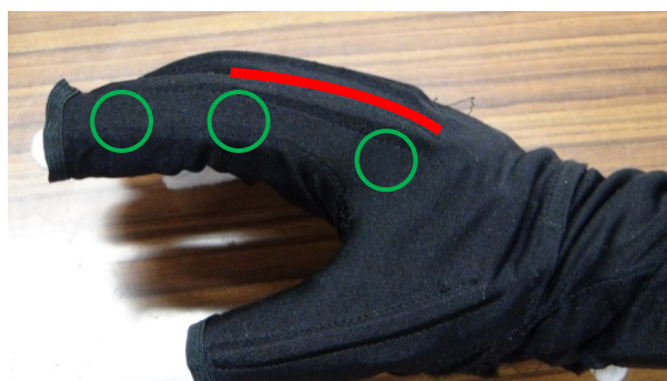
図 2.1: ベンドセンサーの構造
