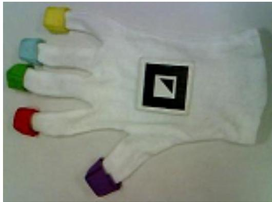
図 2.8: ビジョンベースデータグローブシステム
