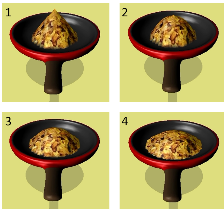
図 4.2: 安息角を越えて積み重なった固体群が崩れる様子
