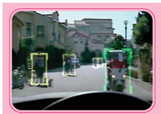
図 3.8: デンソー・ウィンドシールドディスプレイ(将来的イメージ)
