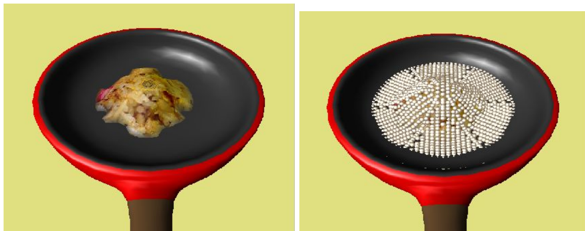
図 11: 格子表現による固体群に沿って配置される表面粒子
