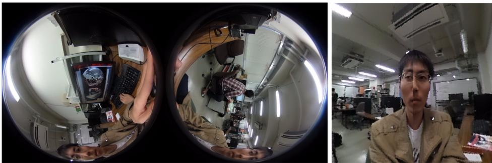
図4 水平に90度回転後, 歪み補正
